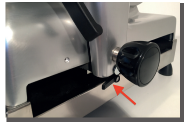
Leva di sgancio carrello per utilizzo in manuale Level to start the manual advance
